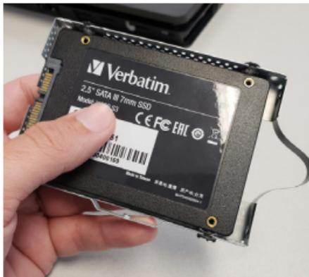
3.8 Los conectores dorados deben estar a la vista y se deben insertar primero en la bahía de la unidad. Deslice el soporte de la unidad con el SSD dentro de la bahía de la PS4™. Asegúrese de deslizarlo completamente para que los conectores queden alineados en el interior.
