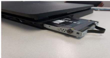
3.9 Coloque nuevamente el tornillo plateado individual en la parte posterior de la cubierta.
