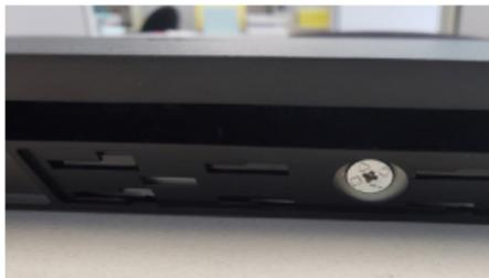
3.4 Con la lengüeta de extracción de la unidad ubicada a lo largo del lateral de la PS4™, extraiga suavemente el HDD y el soporte de la unidad de la bahía de la PS4™.
