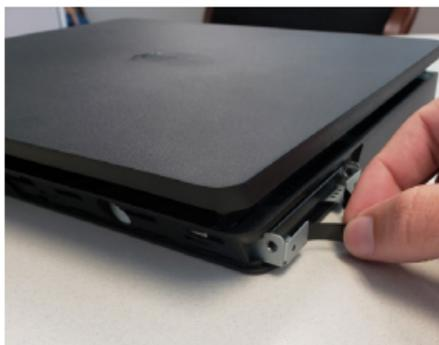
3.8 Les connecteurs en or doivent être visibles et insérés en premier dans le logement d'unité. Remettez dans le logement d'unité du PS4™ le support de disque contenant le SSD. Assurez-vous de le glisser jusqu'au fond en alignant correctement les connecteurs à l'intérieur.
