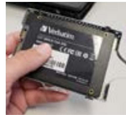
3.8 Les connecteurs en or doivent être visibles et insérés en premier dans le logement d'unité. Remettez dans le logement d'unité du PS4™ le support de disque contenant le SSD. Assurez-vous de le glisser jusqu'au fond en alignant correctement les connecteurs à l'intérieur.
